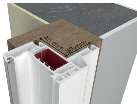
Dormant de rénovation aile de 40 mm avec éloignement de 22 mm pour dos de dormant 48 mm - réf 140x11
